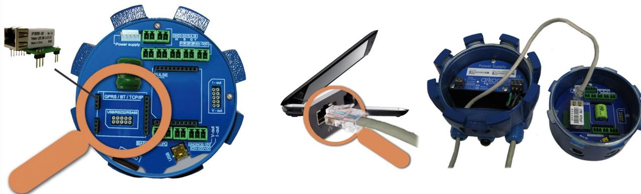
Una condición que debe ser cumplida por el módulo TCP/IP para ser capaz de trabajar correctamente: la velocidad del protocolo de comunicación MODBUS debe ser ajustada a 19200Bd, Parity none, 1 stop bit. Si hay alguna diferencia de ajuste no se efectuará comunicación.
