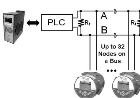
**Terminador  $R_t$  con Resistencia  $100\Omega$  debe conectarse al final de la línea de conexión RS-485.**
