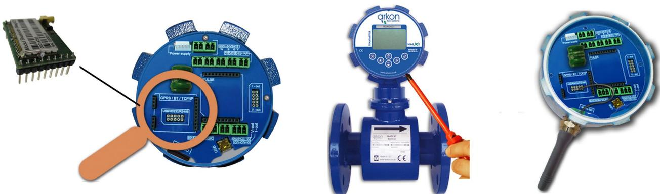
Una condición debe ser cumplida por el módulo Bluetooth para ser capaz de trabajar correctamente: la velocidad del protocolo de comunicación MODBUS debe ser ajustada a 19200Bd, Parity none, 1 stop bit. Si hay alguna diferencia de ajuste no se efectuará comunicación.
